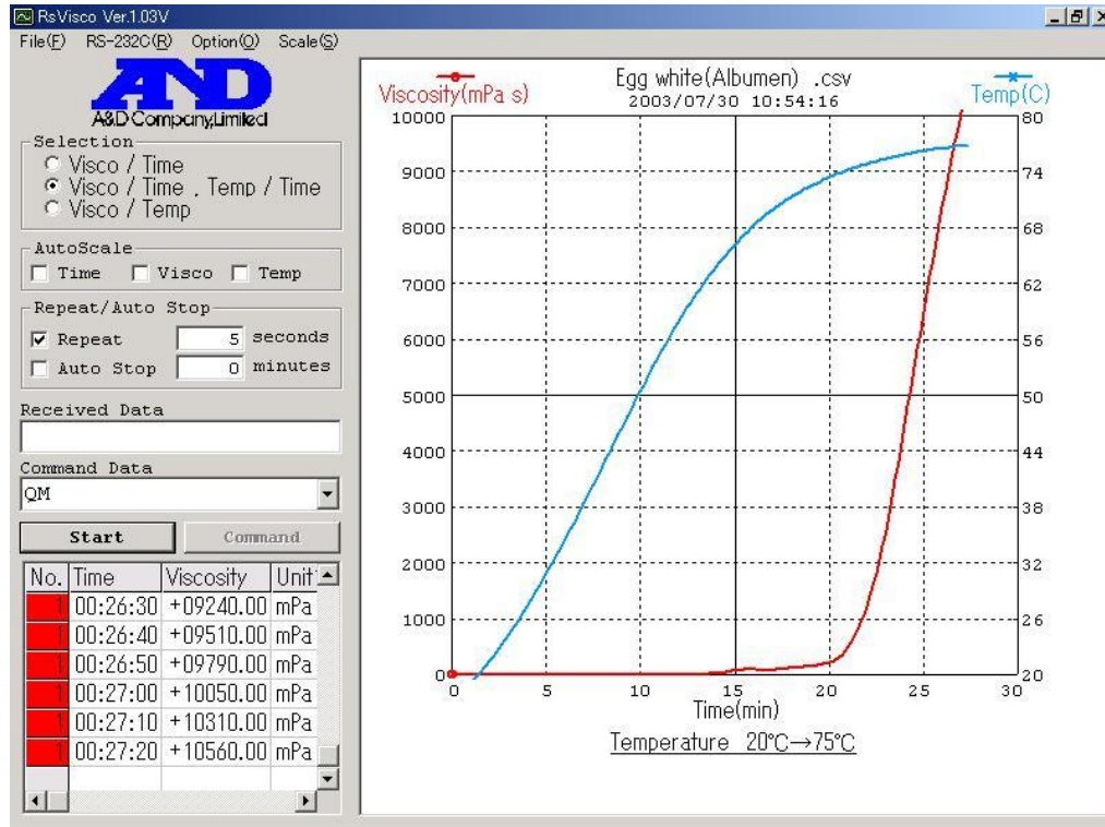
Диаграмма 21. Пример измерения вязкости яичного белка (SV-10)
