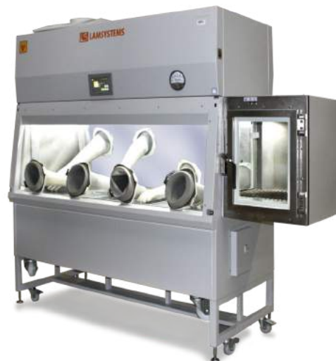
Бокс VIS-A-VIS с разноуровневым расположением перчаточных портов
