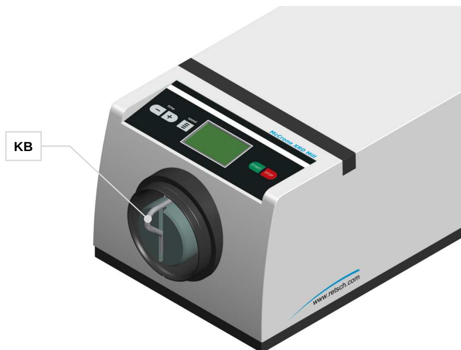
Рис. 12: Закрепление размольного стакана
