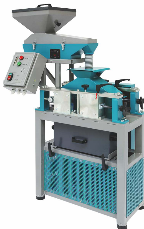
Установка ДВГ 200x125 с Пультотом ПУЗ и Питателем ПГ 1 на опоре
