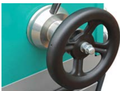
Устройство регулировки зазора между щеками ЩД 15
