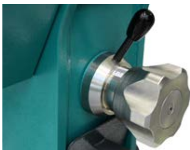
Устройство регулировки зазора между щеками ЩД 6М и ЩД 10М
