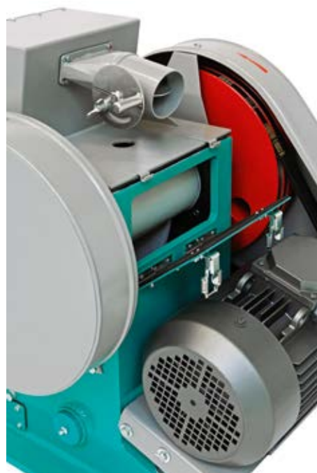
Патрубок для подключения БПУ (системы пылеудаления) и окно для очистки
