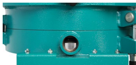
Отверстие для контроля зазора между дисками
