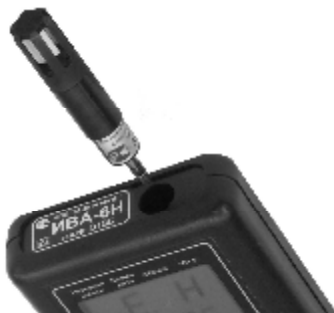
Рис.4. Извлечение преобразователя термогигрометра ИВА-6Н из блока индикации при поверке.
