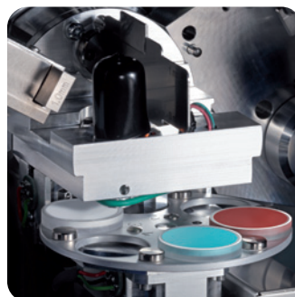
Шестипозиционное устройство смены образцов
