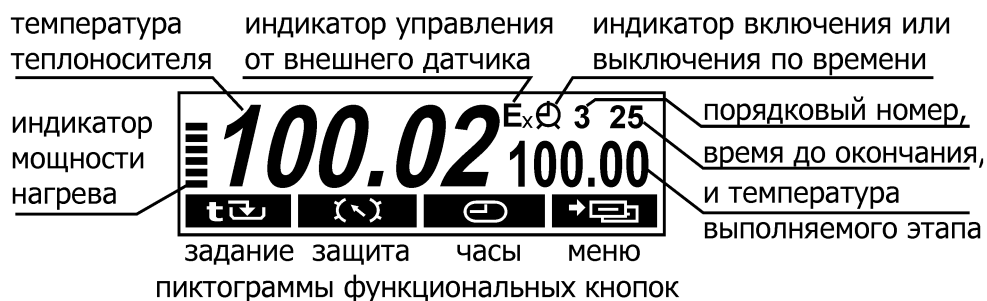
Рисунок 5 — Дисплей в режиме регулирования по программе
