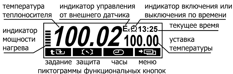
Рисунок 4 — Дисплей в режиме регулирования по уставке
