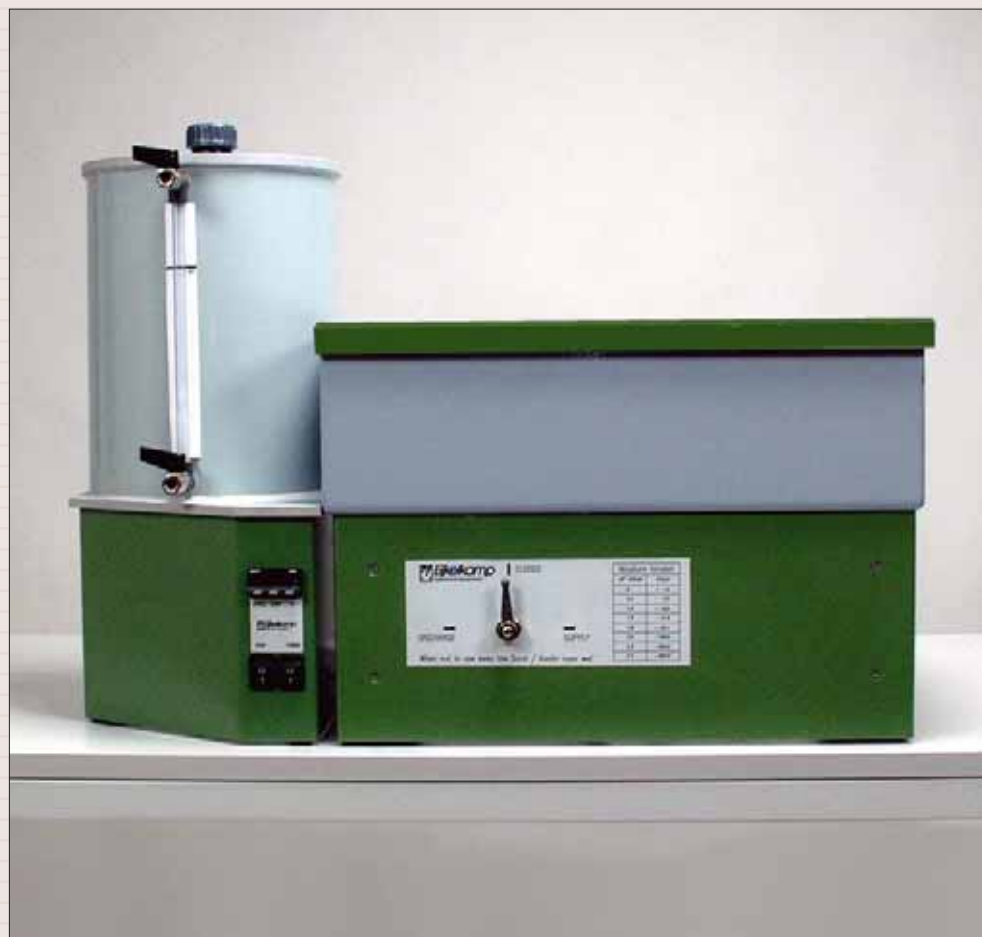
Песочница для песка/каолина для определения рF (рF 2,0 - 2,7)
