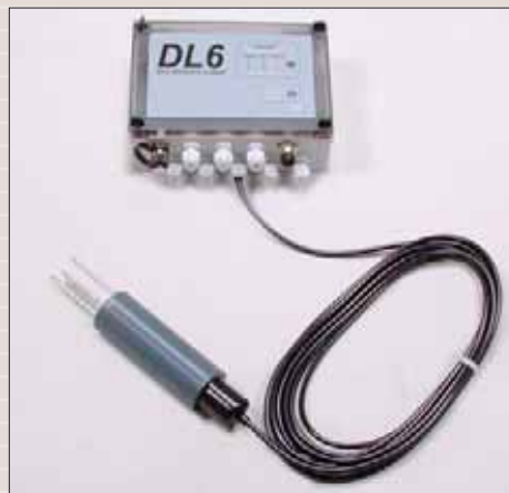
Регистратор с датчиком Thetaprobe
