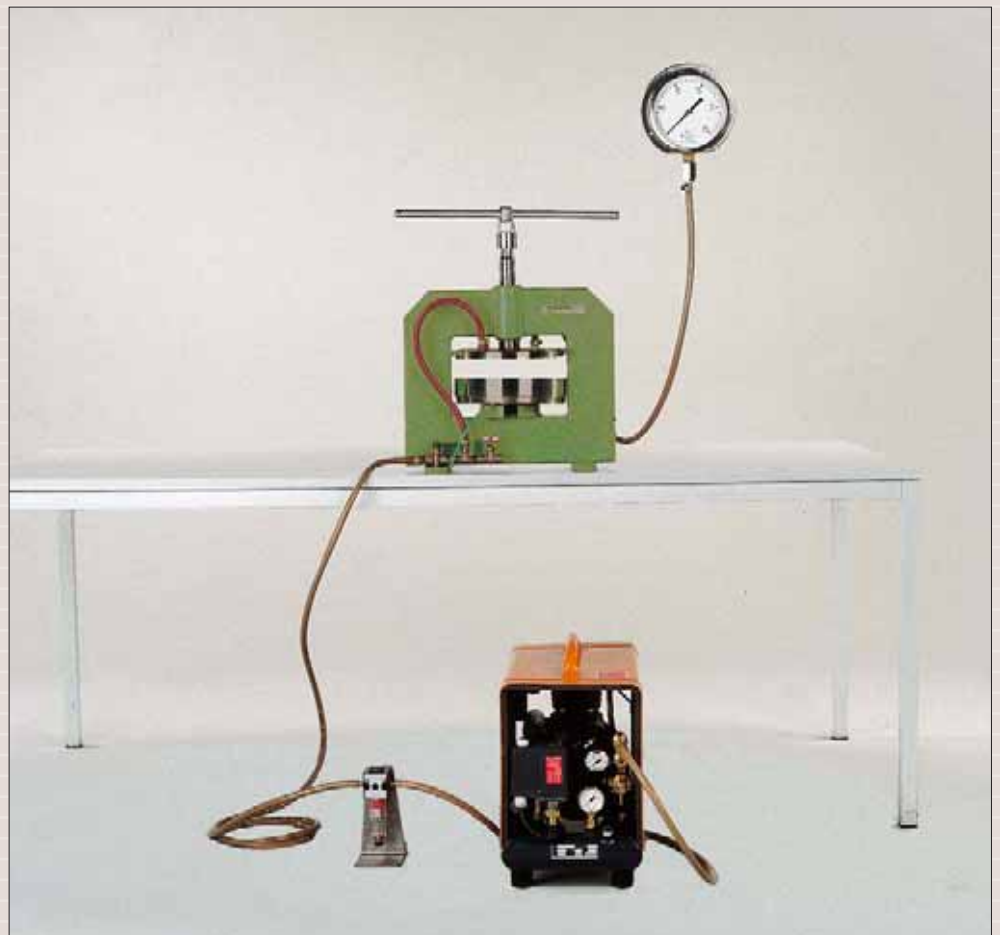
Мембранный аппарат для определения рF (рF 3,0–4,2)
