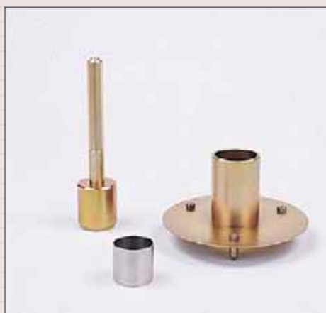
Устройство для забивания кольца и направляющий цилиндр
