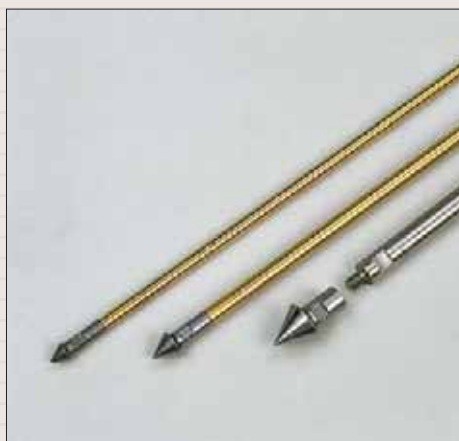
Конусы и устройство для зондирования почвы
