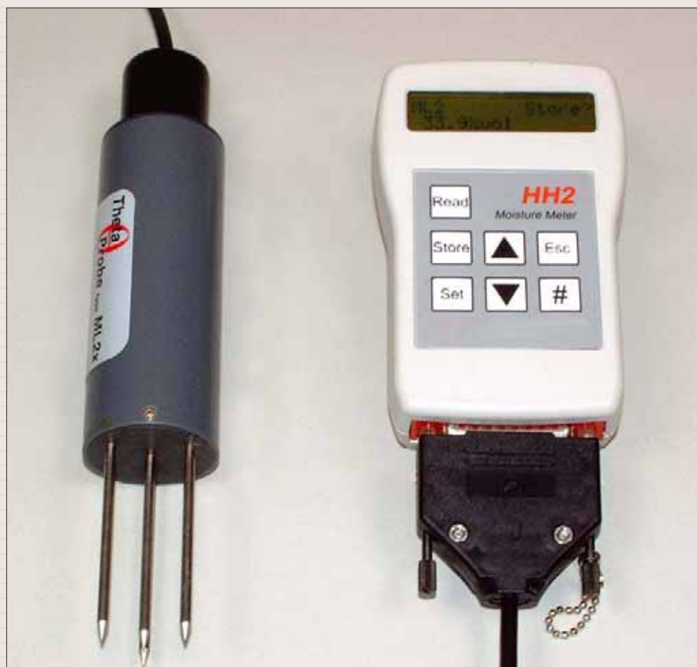
Измеритель влажности с датчиком влажности Thetaprobe
