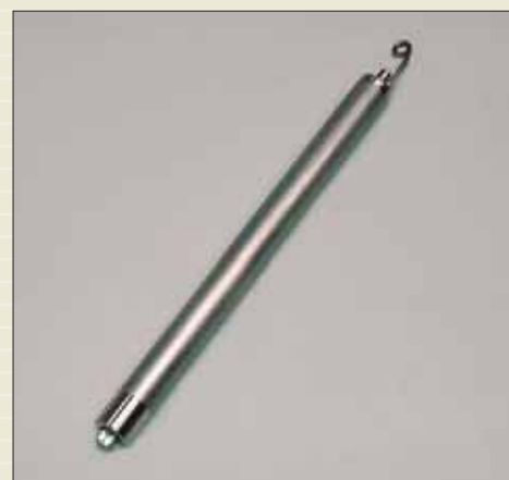
Пробоотборник для отбора на дне резервуара
