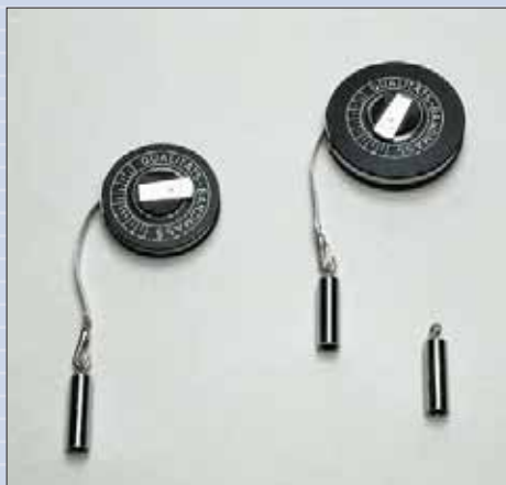
Ручной акустический уровнемер «хлопушка»
