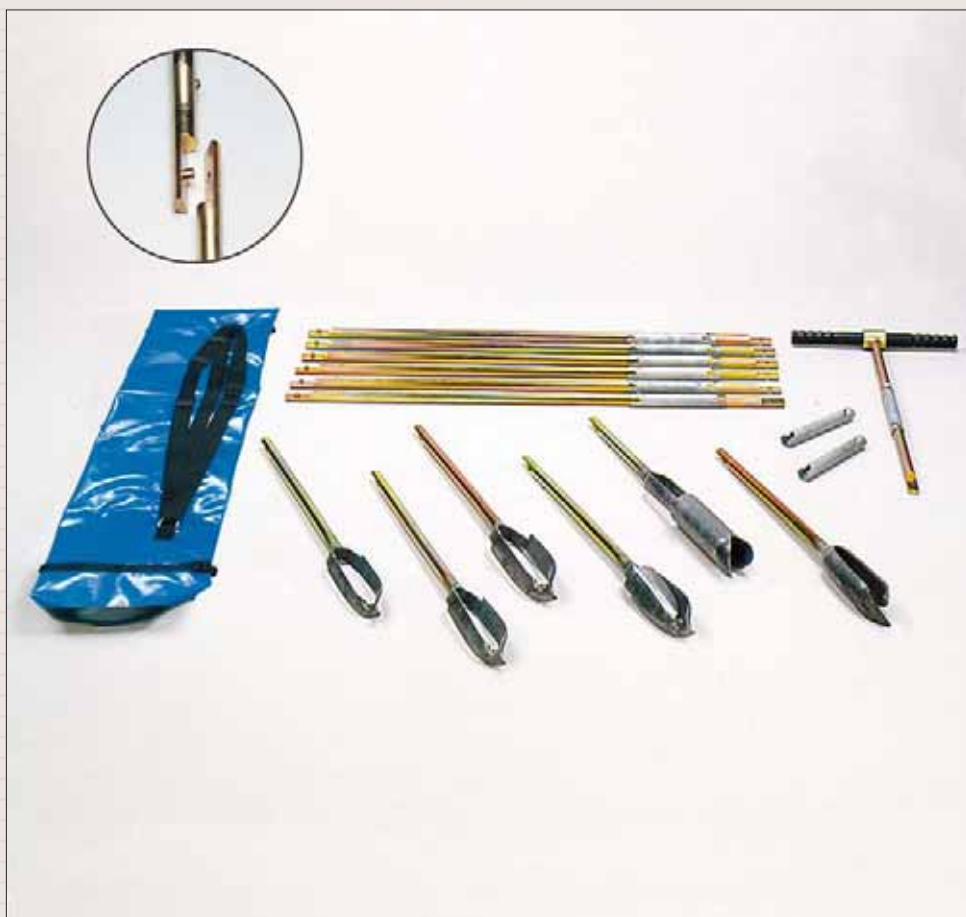
Стандартный набор ручных буров с резьбовым соединением
