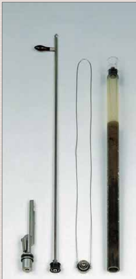
Универсальный пробоотборник в разобранном виде
