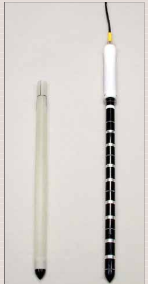
Профильный датчик и тонкостенная трубка
