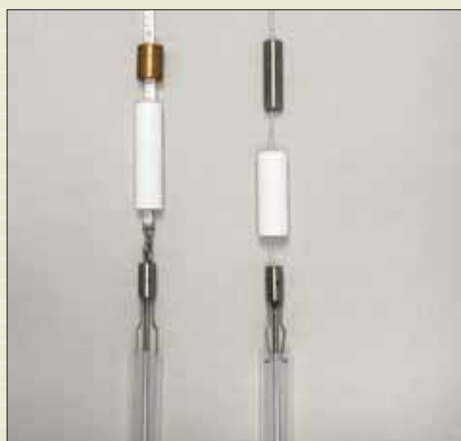
Пробоотборники с устройством, препятствующим воспламенению
