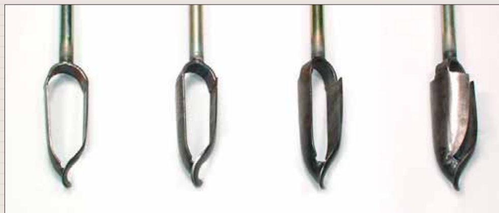
Буры Эдельмана: для глины, для комбинированных почв, для песчаных почв, для крупнозернистых песков
