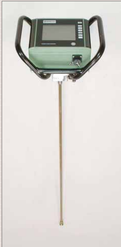
Пенетрологгер с зондом и конусом
