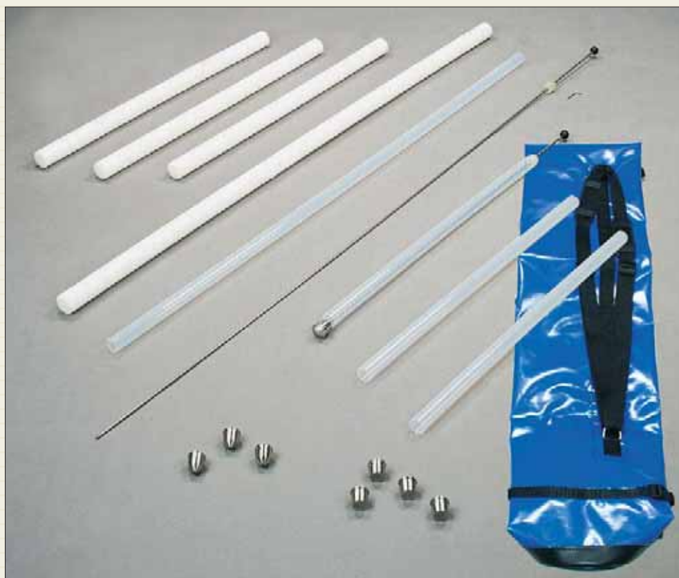
Пробоотборник для послойного анализа жидких сред, управляемый с помощью стержня
