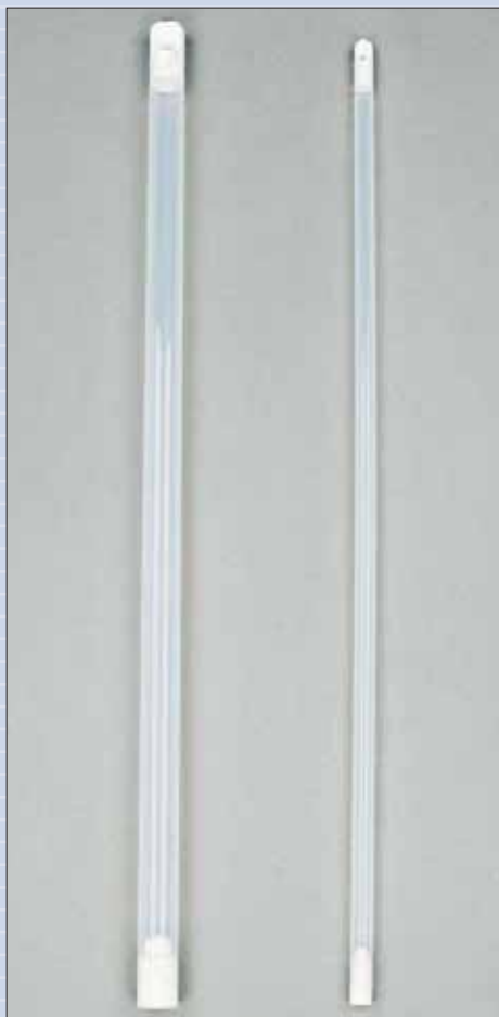
Пробоотборник для воды из тефлона
