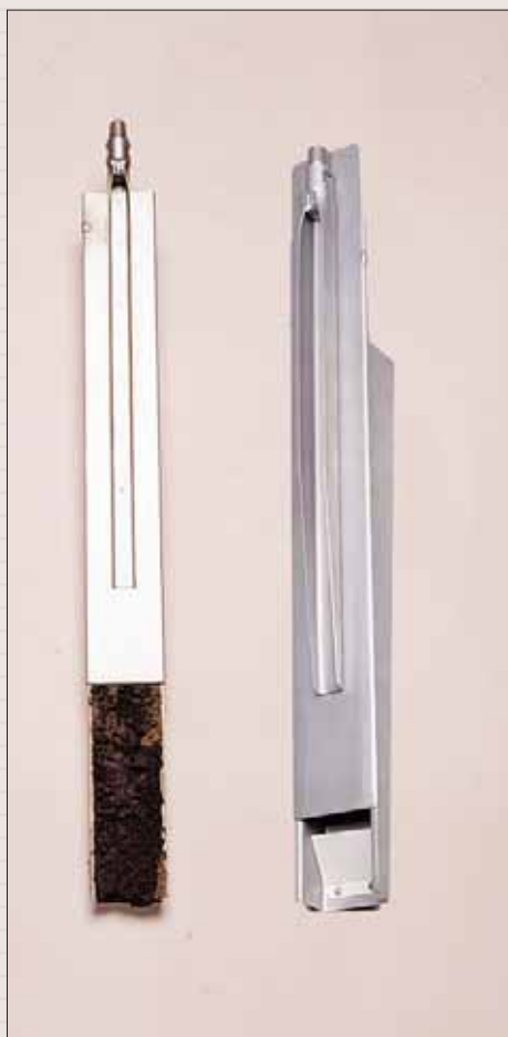
Пробоотборник для торфяных отложений ("Vrijwit auger")
