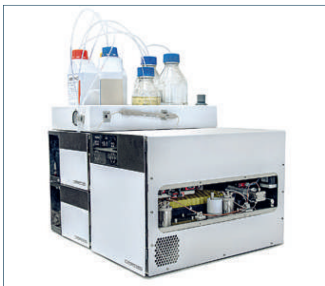
Рис.1. Автоматический дозатор ВЭЖХ "Скорострел" с прямым дозированием пробы (split-loop)
